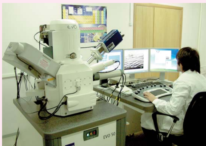
Электронный сканирующий микроскоп позволяет изучать структуру и топографию поверхности материалов.
