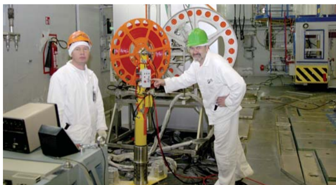
Установка для контроля газового зазора в ядерном реакторе.
