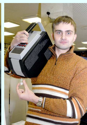
Универсальный спектрометр мобильной подвижности высокого разрешения для анализа газовых и жидких проб (плазменный хроматограф).
