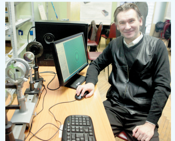
Установка для изучения интерферометра фабрично разработана на кафедре общей физики НИЯУ МИФИ в 2010 году. Основная цель: познакомить студентов с принципом работы и основными характеристиками данного интерферометра, который используется не только как спектроскопический прибор, но и в качестве резонатора лазера.
